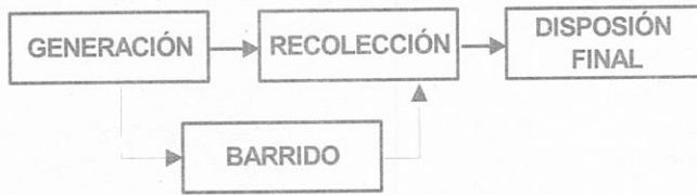
Figura 2. Flujograma de un sistema simple de manejo integral de los residuos sólidos urbanos
